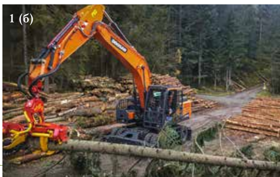
С въжена линия „Valentini – 400“ се извозват цели дървета до камионен път (а), където кастренето и разкрояването на сортименти се извършва с кран-процесор „Woody H 60“, монтиран на колесен багер „Doosan“ (б)
