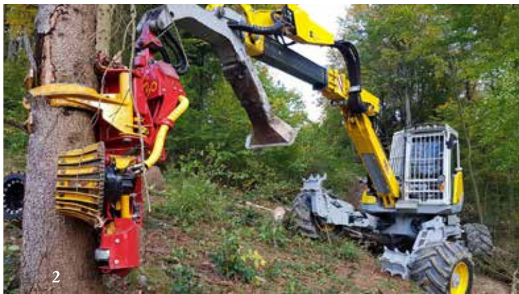
Харвестър „Menzi-Muck“ с монтирана процесорна глава „Woody H 50“ провежда отгледна сеч на стръмен терен
