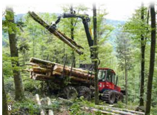
Напълно механизирани дърводобив на стръмен склон – харвестър „John Deere“ с допълнително монтирана тракционна лебедка
