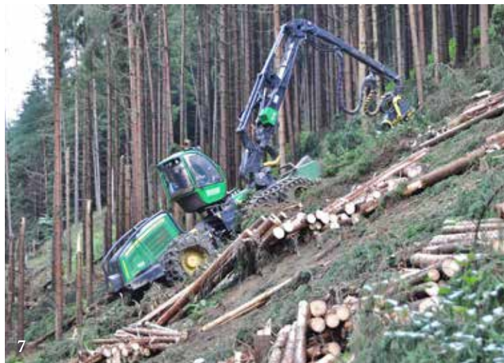
Напълно механизирани дърводобив на стръмен склон – харвестър „John Deere“ с допълнително монтирана тракционна лебедка
