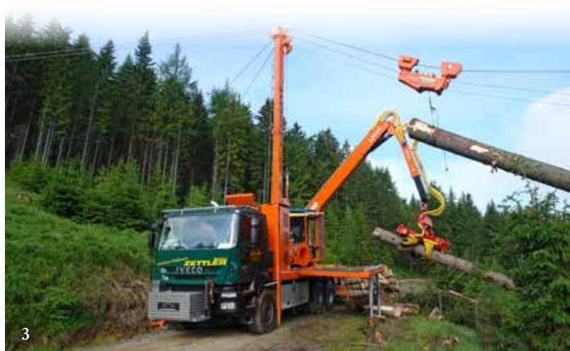
Комбинирана мобилна въжена линия (планински харвестър) „Syncrofalke 3t“, монтирана върху базовото шаси на товарен автомобил „Iveco“ и процесор „Woody H60“, монтиран на стрелата на кран
