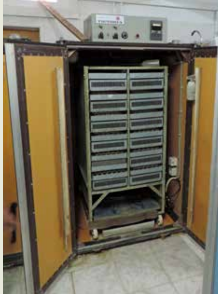
Инкубаторът за яйца и шкаф за доизлюпване
