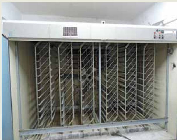
Инкубаторът за яйца и шкаф за доизлюпване
