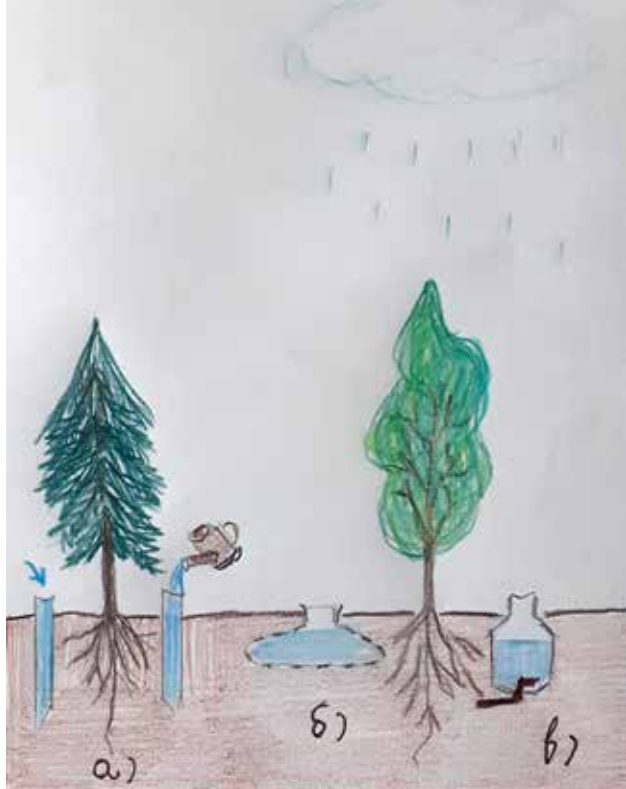
Фиг. 4. Системи за напояване: а) директно дълбоко напояване б) порести стени в) фитил за напояване
