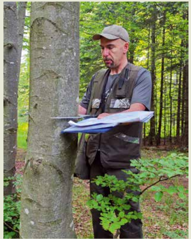
Контролно замерване на диаметъра на буково стъбло
