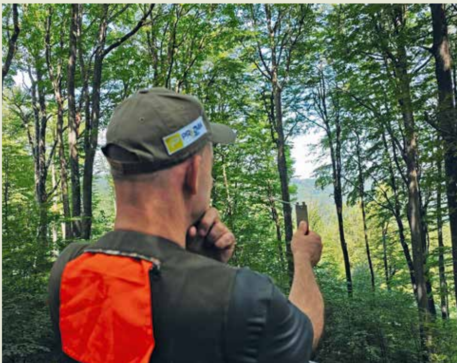
Определяне на кръгова площ на насаждението по метода на Битерлих
