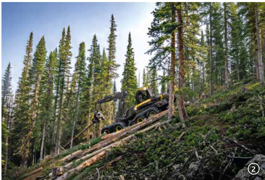
Харвестър Ponsse с тракционна лебедка Alpine Synchronwinch, извеждаща отгледна сеч в смърчово насаждение при наклон 58 %
