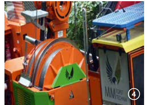
Двата синхронизирани барабана за теглещото и връщащото въже
