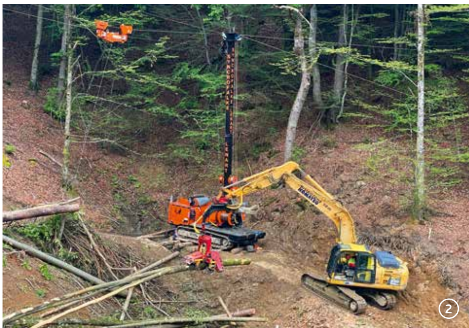
Работа на системата на тракторен път с наклон 15 %, изработен от багера, и работна площадка на въжената линия, работеща на спускане при добив на букова дървесина. Обработката и разкрояването се поемат от багер-процесора (технология, приложена в Словения)
