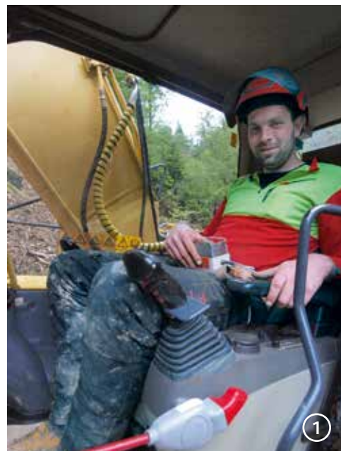
Операторът на багера управлява с пулт за дистанционно управление и въжената линия
