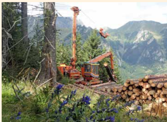
Комбинирана въжена линия „планински харвестър“ Syncrofalke на товарен автомобил
